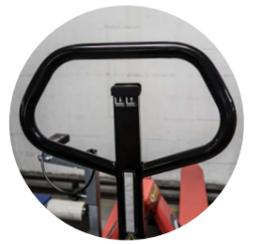
Poignée correcte sur le plan ergonomique / arrêt d'urgence en position centrale
