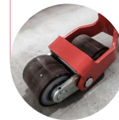
Roues doubles à l'avant pour augmenter la stabilité et éviter les traces de freinage
