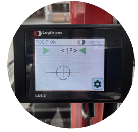
Écran intuitif pour prédéfinir les angles et la vitesse de rotation
