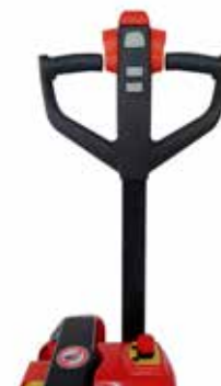
Timón ergonómico con superficies de agarre suaves. Regresa con suavidad a la posición vertical. Puede funcionar con el timón en posición vertical.
